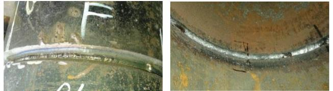
(c) Root pass outer 5R position (d) Root pass penetration 5R position
