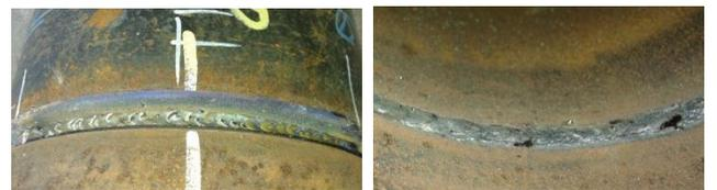
(c) Root pass outer 5R position (d) Root pass penetration 5R position
