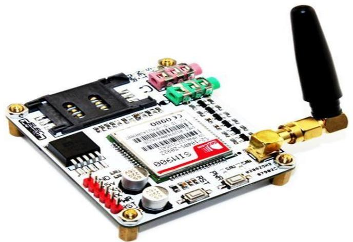
**Fig. 6:** GSM Module
