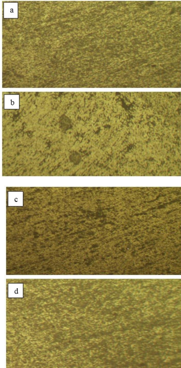
**Figure 8.** Microstructures of (a) Nugget zone (b)TMAZ (c) HAZ (d) Parent metal
